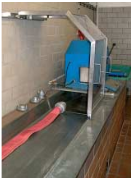
Abschirmungen gegen Nässe und den Wasserstrahl platzender Schläuche.
